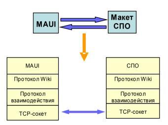
Сообщения интерфейса Wiki инкапсулируются в сообщения протокола взаимодействия [5], которые и передаются между СПО и Maui через установленное TCP-соединение. Для защиты протокола используется вычисление контрольной суммы сообщения по алгоритму DES.
