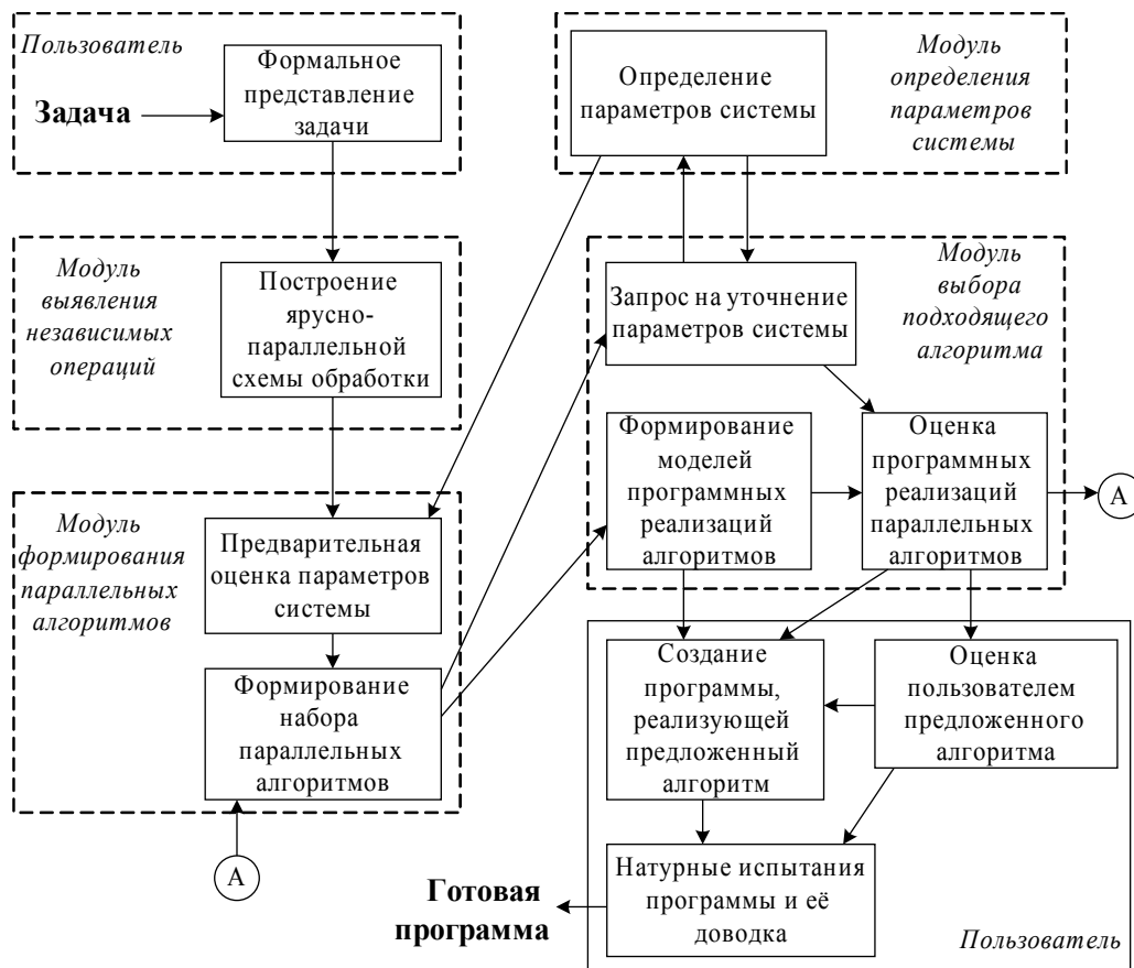
Рис. 2. Схема реализации сервиса для автоматизированной подготовки задач пользователей
