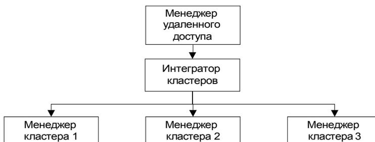
Рис. 1. Схема взаимодействия компонент «Метакластера»
