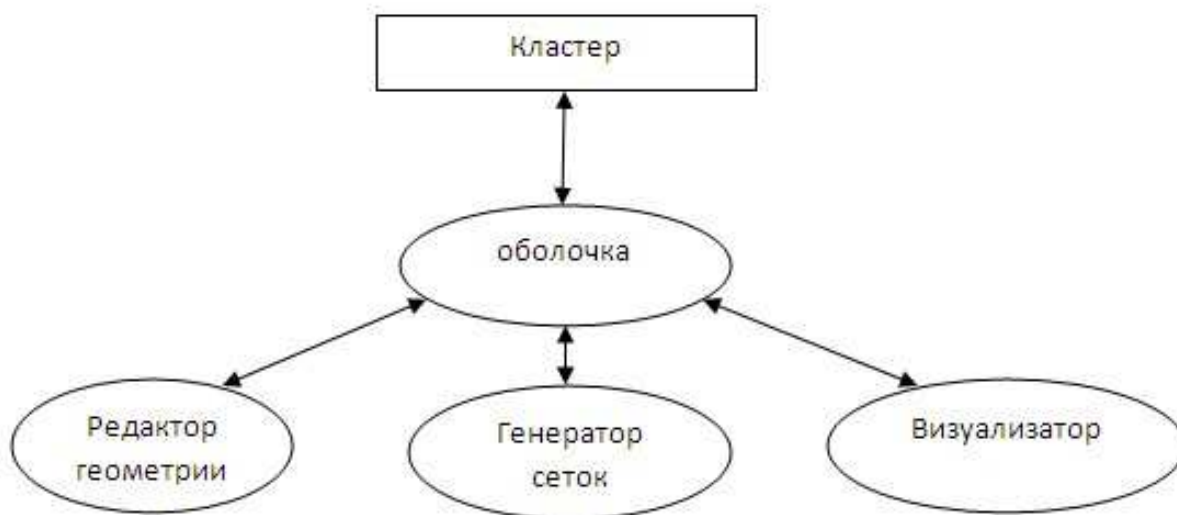
Рисунок 1. Схема взаимодействия компонентов программного комплекса.
