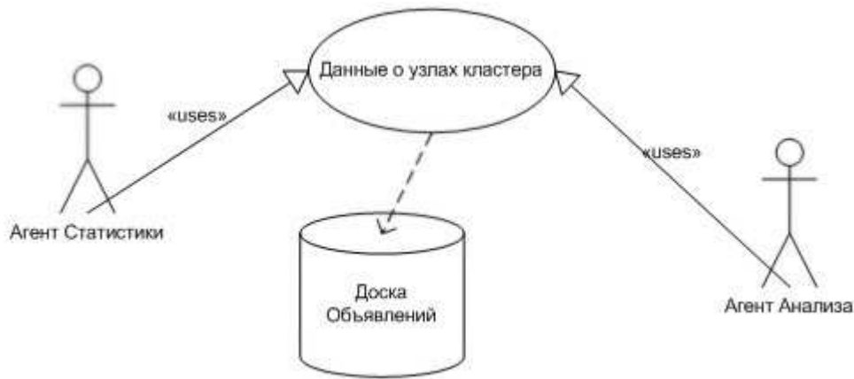
Рис. 3. Взаимодействие агента анализа и агента-датчика вычислительной системы
