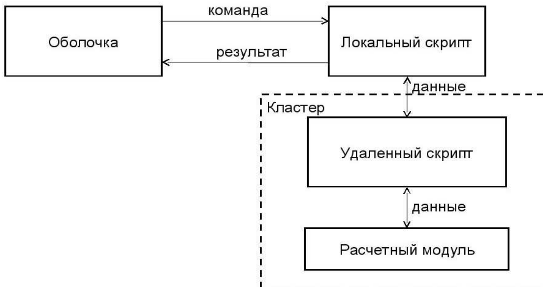
Рис. 2. Схема взаимодействия комплекса GIMM с вычислительным кластером
