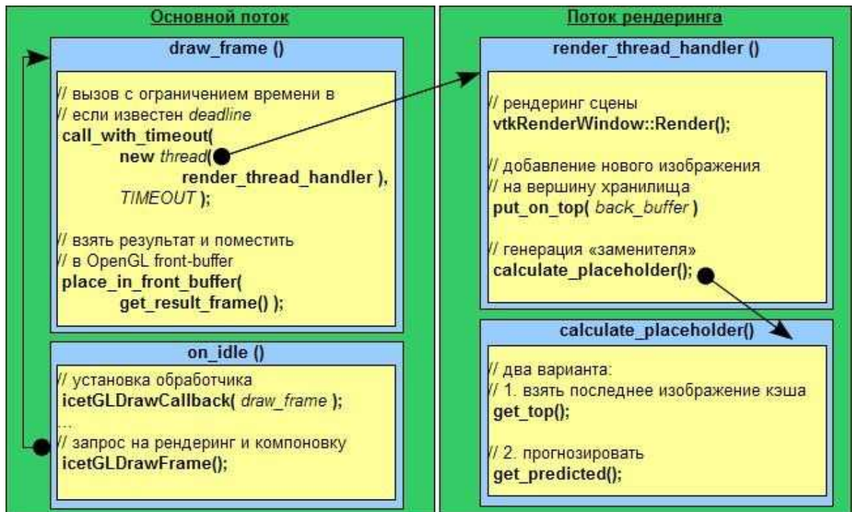
Рис. 3. Схема взаимодействия потоков при использовании рендеринга с ограничением по времени.
