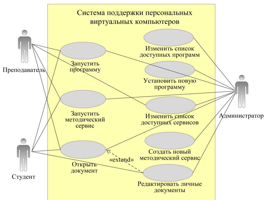
Рис. 1. Диаграмма вариантов использования системы «Персональный виртуальный компьютер».
