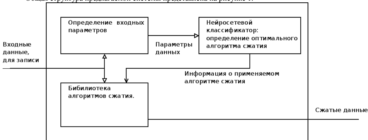
Рис. 1 Потоки данных в системе автоматического выбора алгоритма сжатия.
