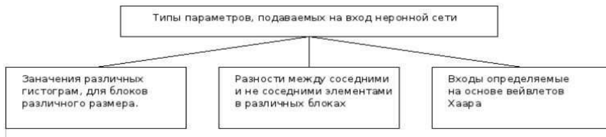
Рис. 2 Классификация параметров данных, подаваемых на вход нейросети.
