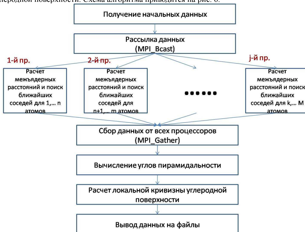
Рис. 6 Схема работы параллельной программы «Curvature»
