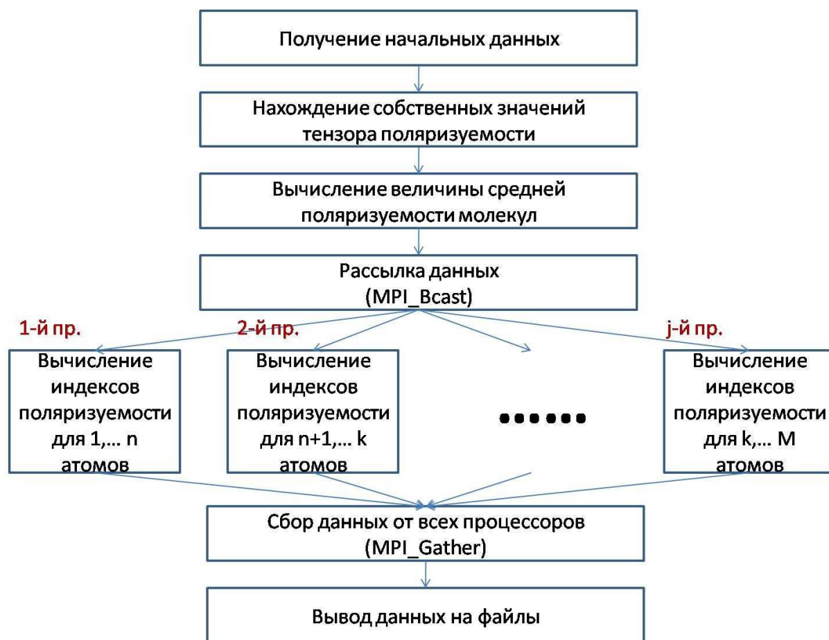
Рис. 5 Схема работы параллельной программы «Polariz»
