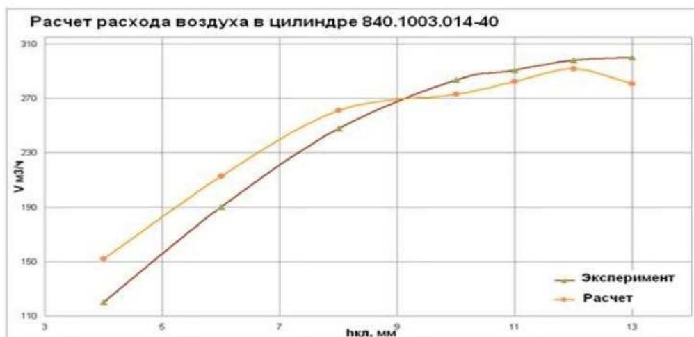
Рис. 1 Графики зависимости расхода воздуха от хода клапана
