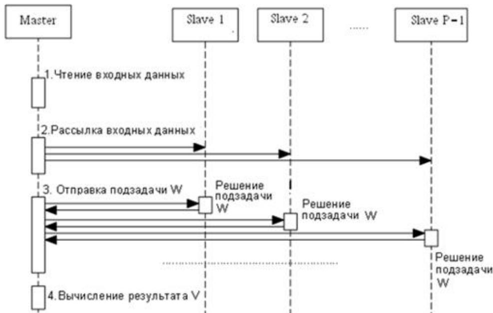
Рис. 1. Диаграмма последовательности действий параллельных процессов
