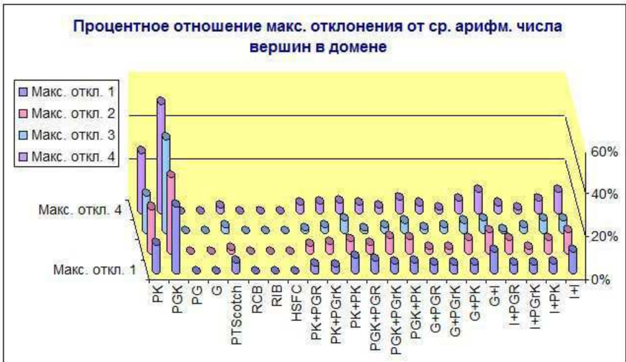
Рис. 5. Процентное отношение максимального модуля отклонения от среднего арифметического числа вершин в домене в разбиениях тетраэдральных сеток на 512 доменов.
