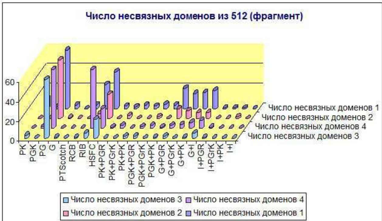
Рис. 7. Число несвязных доменов в разбиениях тетраэдральных сеток на 512 доменов (фрагмент).
