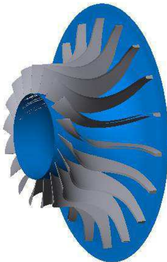
Рис. 1. Внешний вид осерадиального РК компрессора
