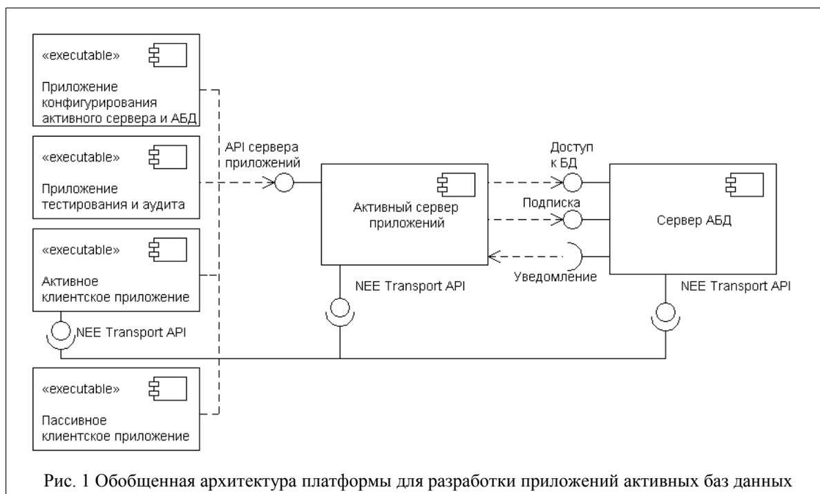
Рис. 1 Обобщенная архитектура платформы для разработки приложений активных баз данных
