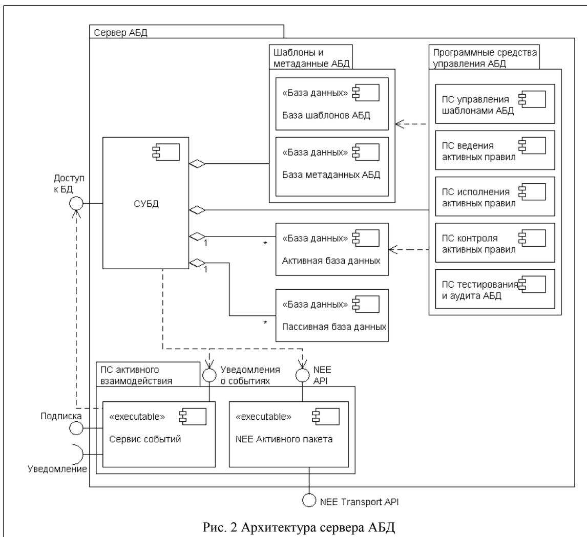
Рис. 2 Архитектура сервера АБД
