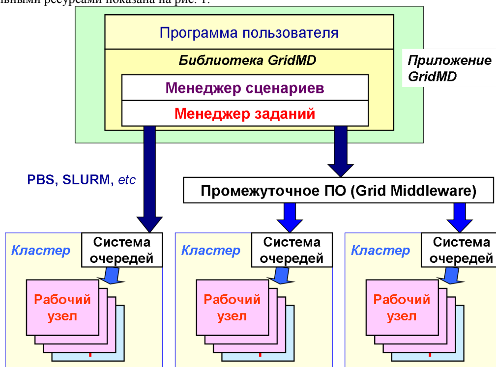
Рис. 1. Запуск задач с использованием программы, созданной на основе библиотеки GridMD
