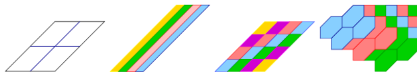
Рис.2. а) Разбиение LRnLA ячейки; разные формы ConeTur отмечены разными цветами. б) Зависимости между элементарными конусоидами, асинхронные конусоиды имеют один цвет. в) Декомпозиция ConeTur
