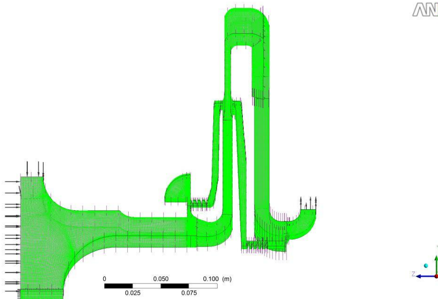
Рис.2 Единая расчетная сетка компрессора с заданными граничными условиями
