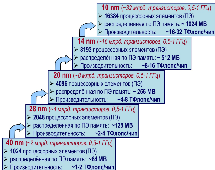
Рис. 2. Масштабирование реализаций высокопараллельной архитектуры ПС2000М по мере развития полупроводниковых технологий.
