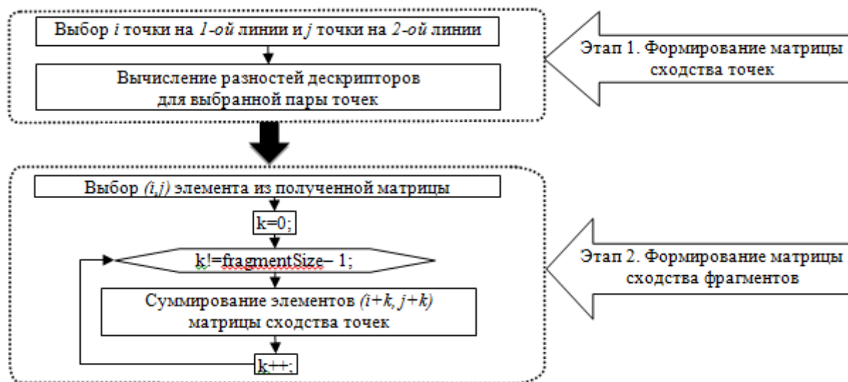
Рис. 2. Параллельная схема реализации блока алгоритма на CUDA
