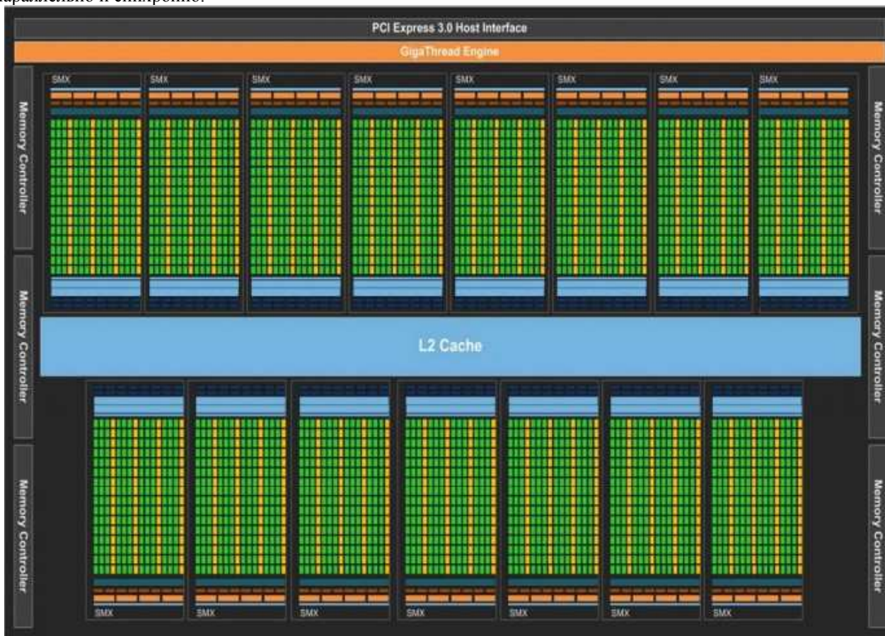
Рис. 1. Структура чипа GK110
