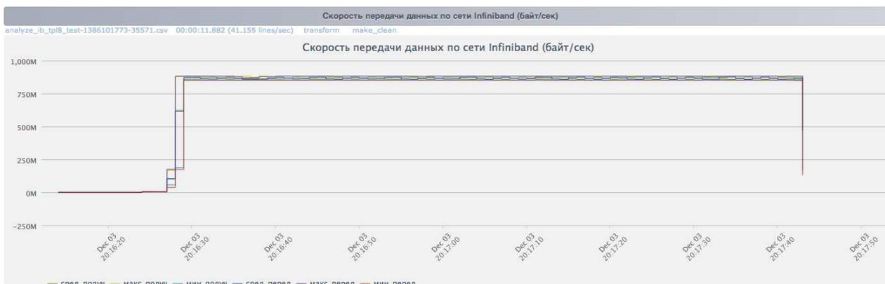
Рис. 2. Скорость передачи данных по сети Infiniband (длина 1 000 000), тест «butterfly»
