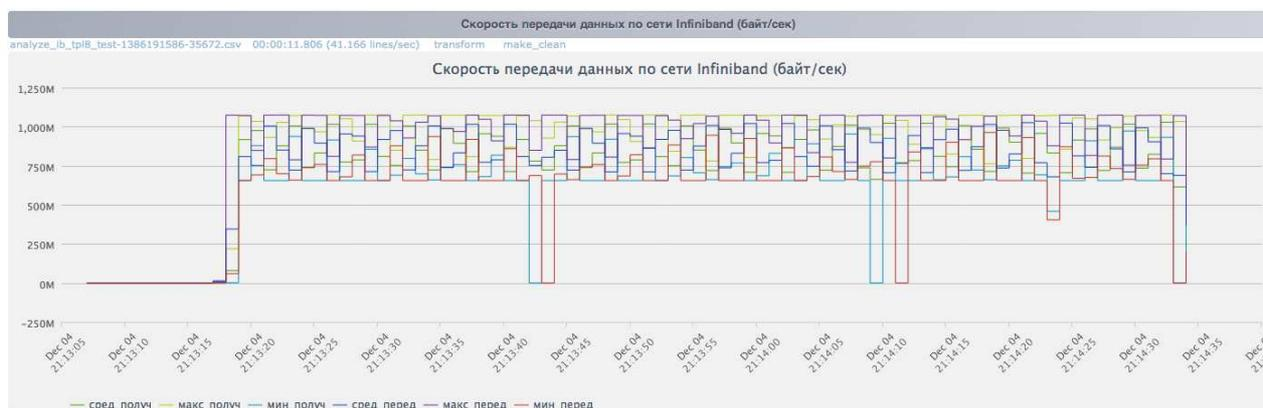
Рис. 4. Скорость передачи данных по сети Infiniband (длина 100 000 000), тест «butterfly»
