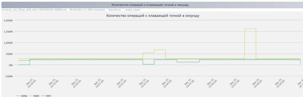
Рис. 13. Количество операций с плавающей точкой в секунду, перемножение матриц (размер 512x512)
