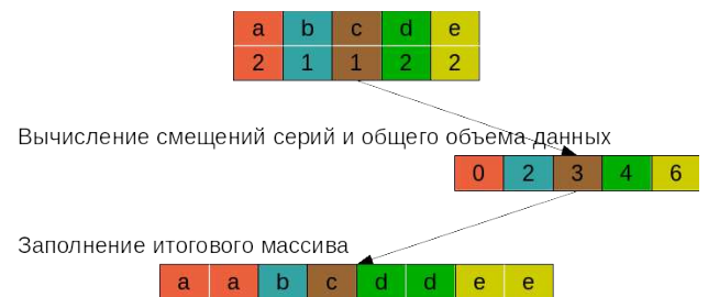
Рис. 2. Схема выполнения распаковки данных, сжатых методом Null Suppression
