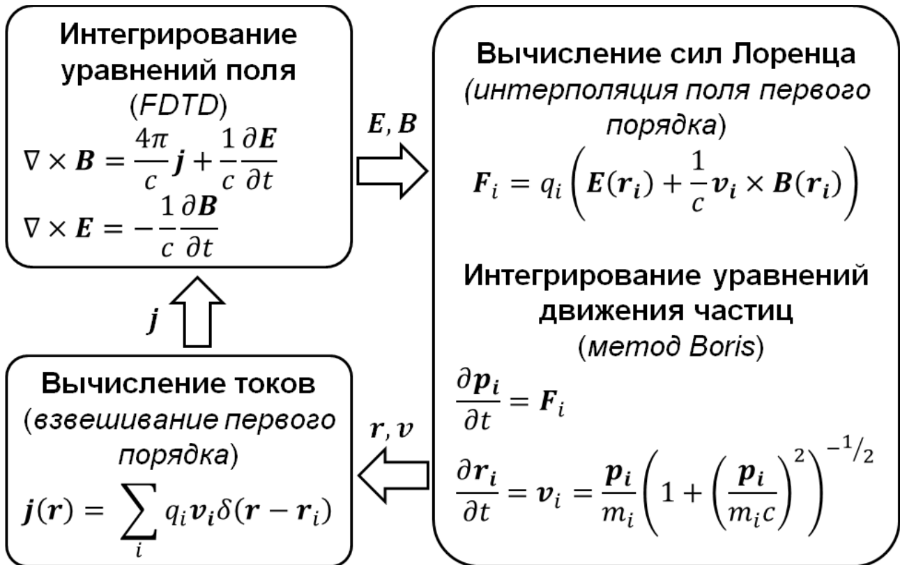
Рис. 1. Вычислительная схема метода частиц в ячейках. В скобках указаны численные схемы, реализованные в программном комплексе PICADOR.
