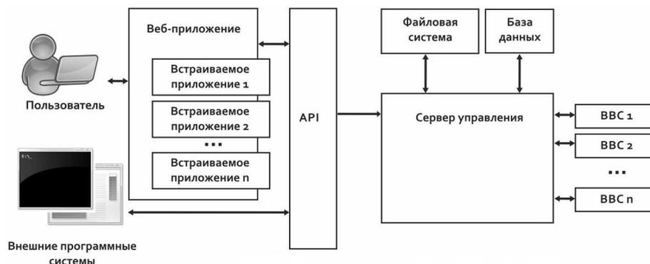
Рис. 2. Архитектура программного инструментария HPC2C
