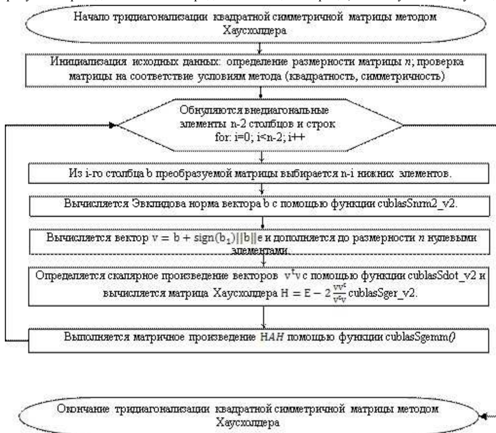
Рис. 2. Блок-схема параллельного алгоритма поиска собственных значений матрицы с применением метода Хаусхолдера
