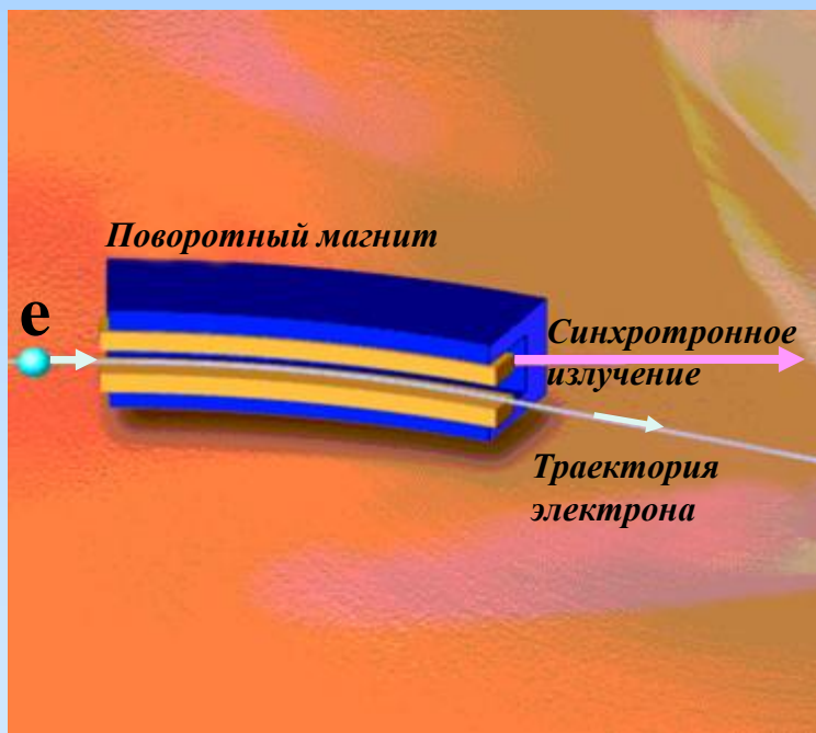
Схема возникновения синхротронного излучения
