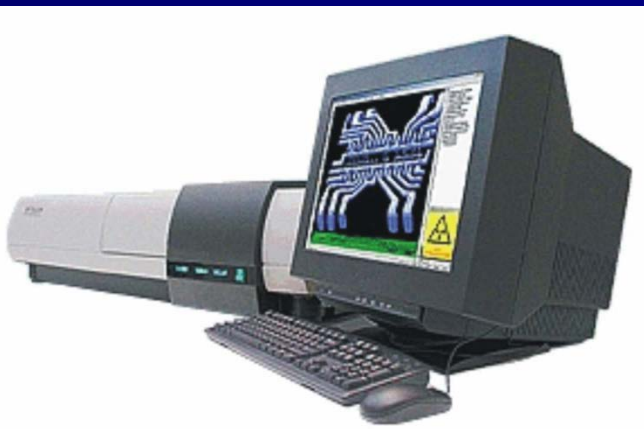
SkyScan-1172 high-resolution micro-CT Пространственное разрешение: ~ 2 мкм X-ray source: 20-100 kV, 0-250 µA, spot size < 5 мкм X-ray detector: 1024x1024 12-bit digital cooled CCD
