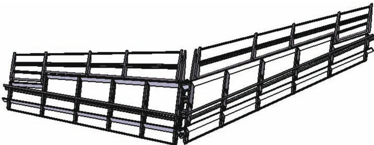
Рисунок 15 – Параметризованный каркас горизонтального оперения<sup>1</sup>
