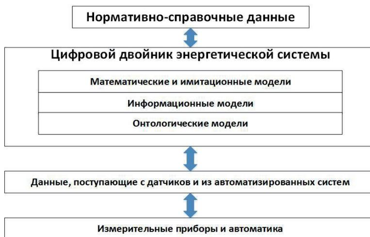
Рисунок 1 – Архитектура цифрового двойника энергетической системы
