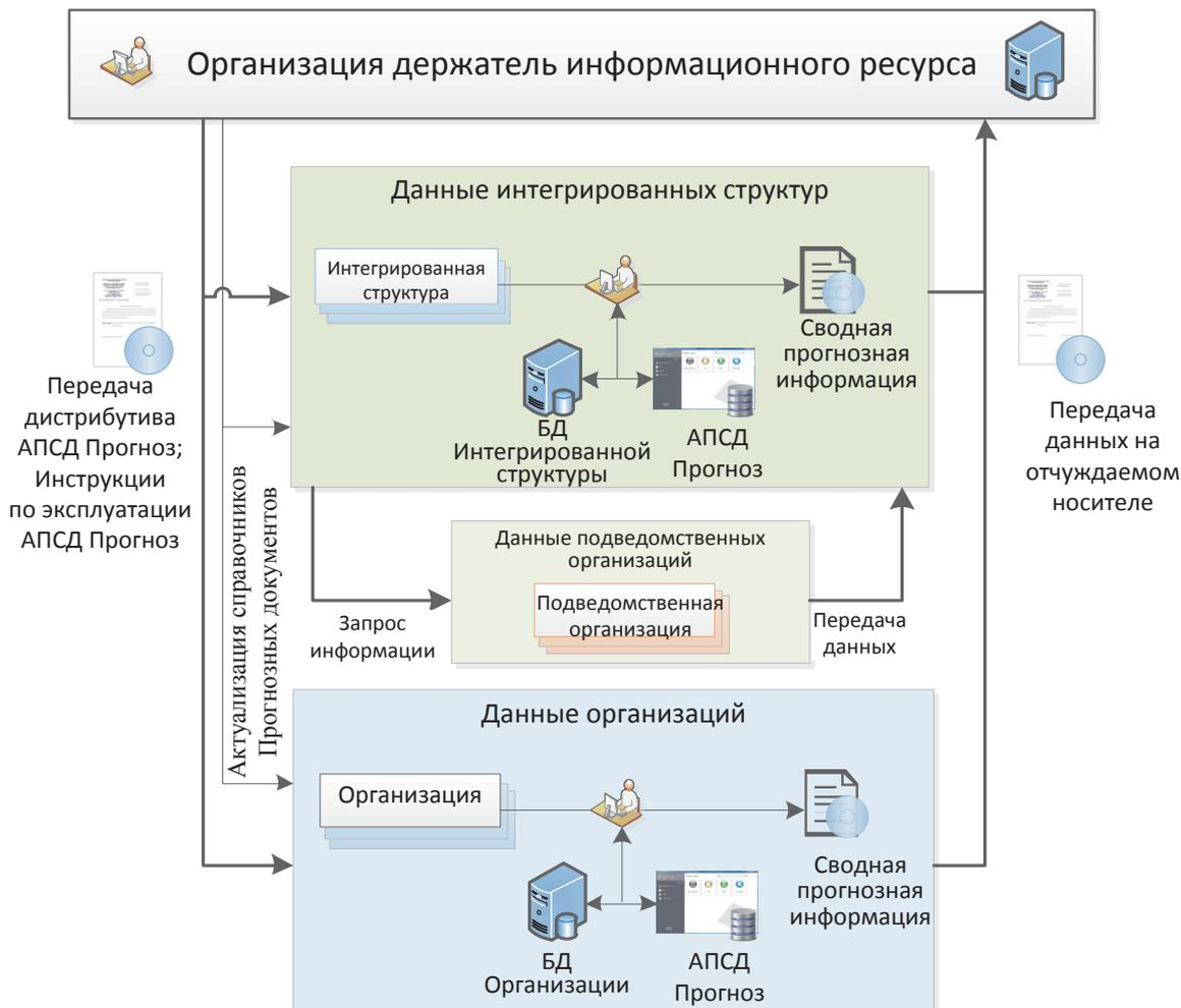
Рисунок 4 – Организационно-технологическая схема сбора данных на основе применения АПСД Прогноз
