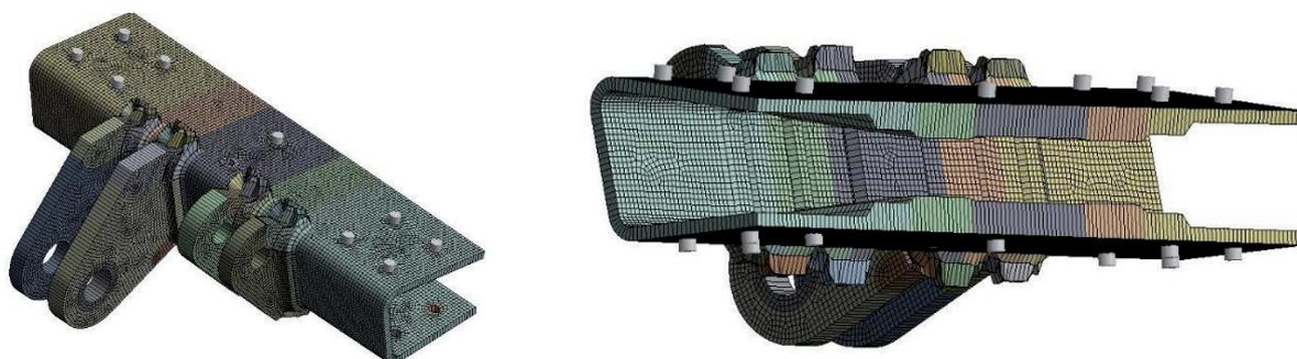
Рисунок 6 – Конечно-элементная модель со слоистой структурой (для наглядности визуализированы толщины элементов)
