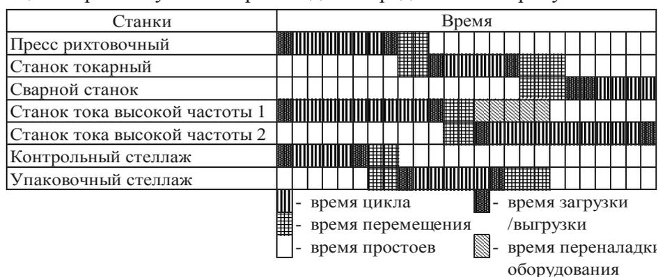
Рисунок 4 – Фрагмент циклограммы ПП для ТСБУ
