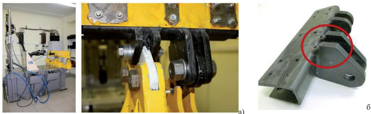
а – испытательная машина и оснастка; б – зона разрушения конструкции
