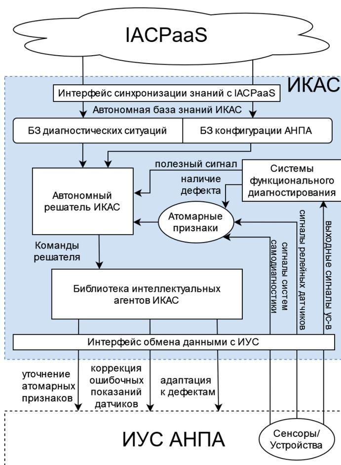
Рисунок 1 – Обобщённая структурная схема работы ИКАС
