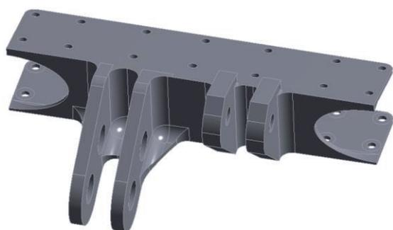
Рисунок 2 – Конструкция металлического кронштейна навески интерцептора
