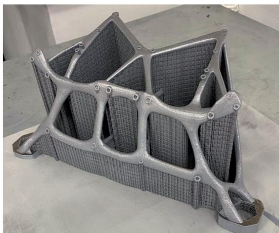
Рисунок 12 – Результат 3D печати силовой конструкции рамы
