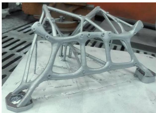
Рисунок 13 – Внешний вид образца после удаления материала поддержки
