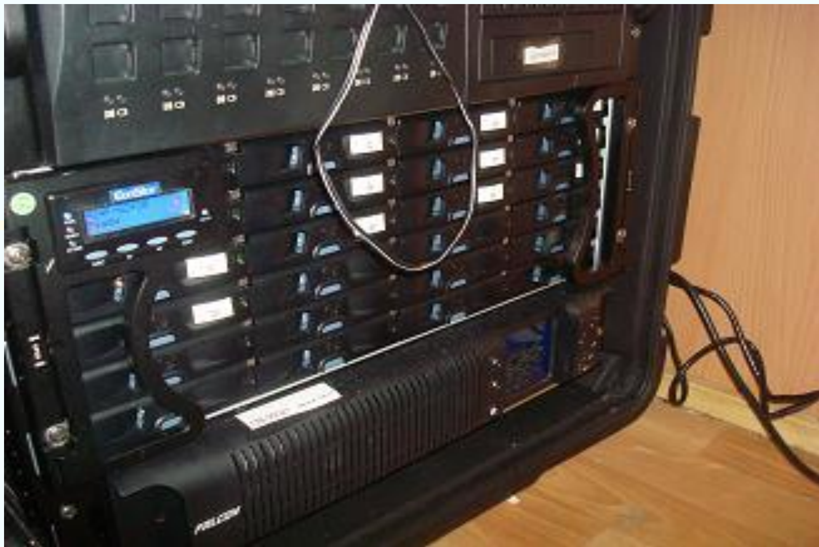
Блок управления системой GeoRes-XTC (для формирования стандартных сейсмограмм, используя информацию, полученную из модуля передачи данных)
