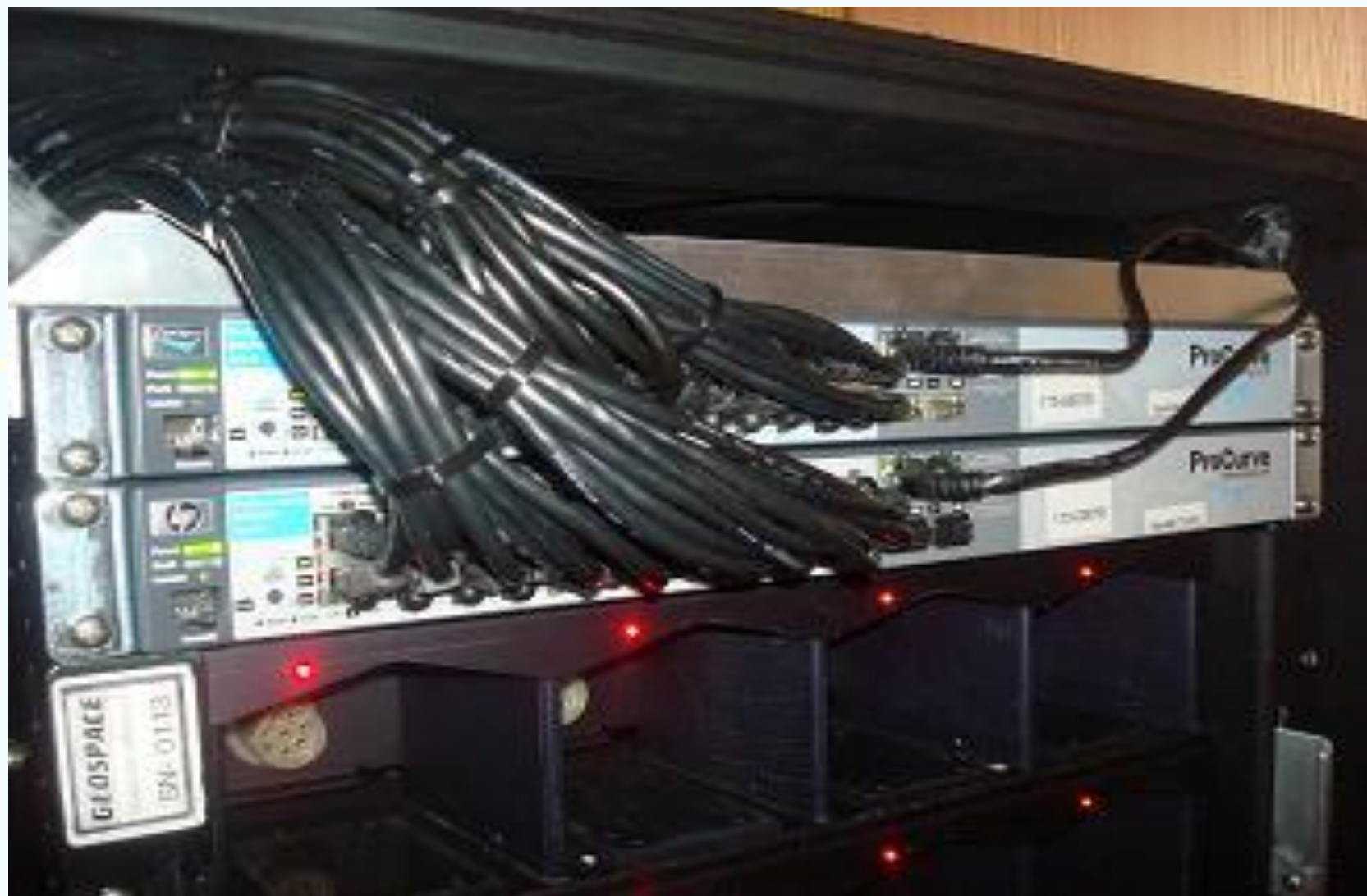
Модуль передачи данных Data Transfer Module (DTM), (для скачивания данных с блоков GSR)
