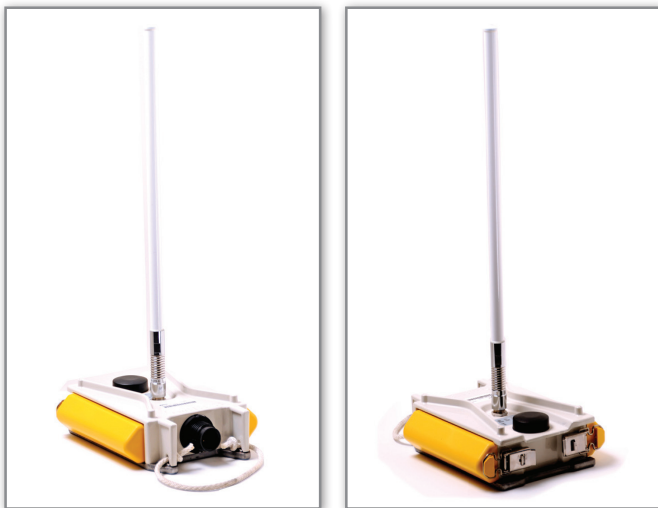
Рис. 1. На внешней части корпуса WRU расположены: антенна повышенной прочности диапазона 2,4 ГГц; стандартный разъем геофона; антенна GPS; статусные индикаторы и две аккумуляторные батареи (по одной с каждой стороны)
